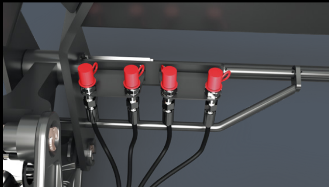
3ª Y 4ª FUNCIÓN. (sistema de enganche por boquilla) Para el manejo fácil de implementos hidráulicos como cazo de ensilado, pinza para pacas o elevador apilador de pacas.
